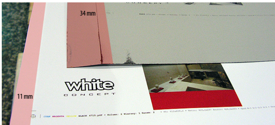
Przykład: dla maszyny drukarskiej KBA 74 wartości chwytu wynosi 34 mm, marginesu technicznego – 11 mm.
